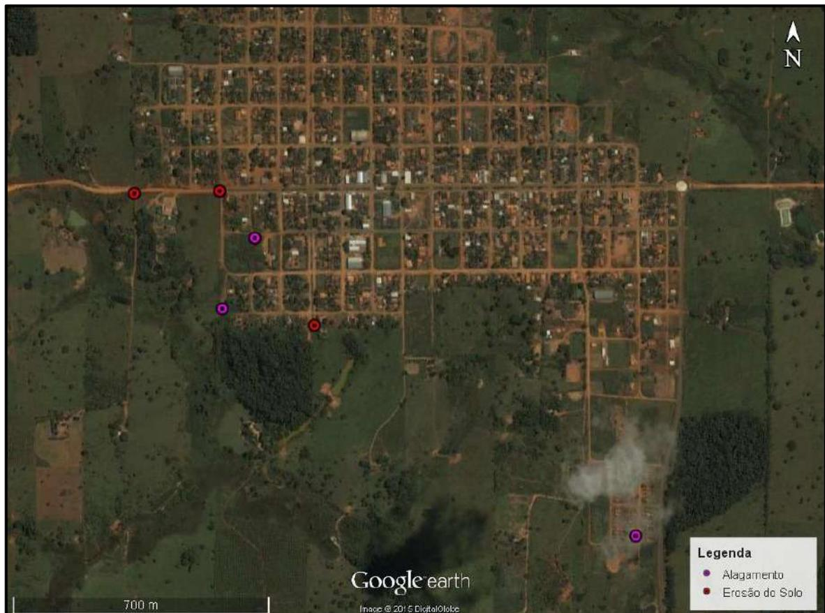
Figura 64. Localização dos principais problemas com drenagem das águas pluviais na Sede Municipal de Corumbiara.
